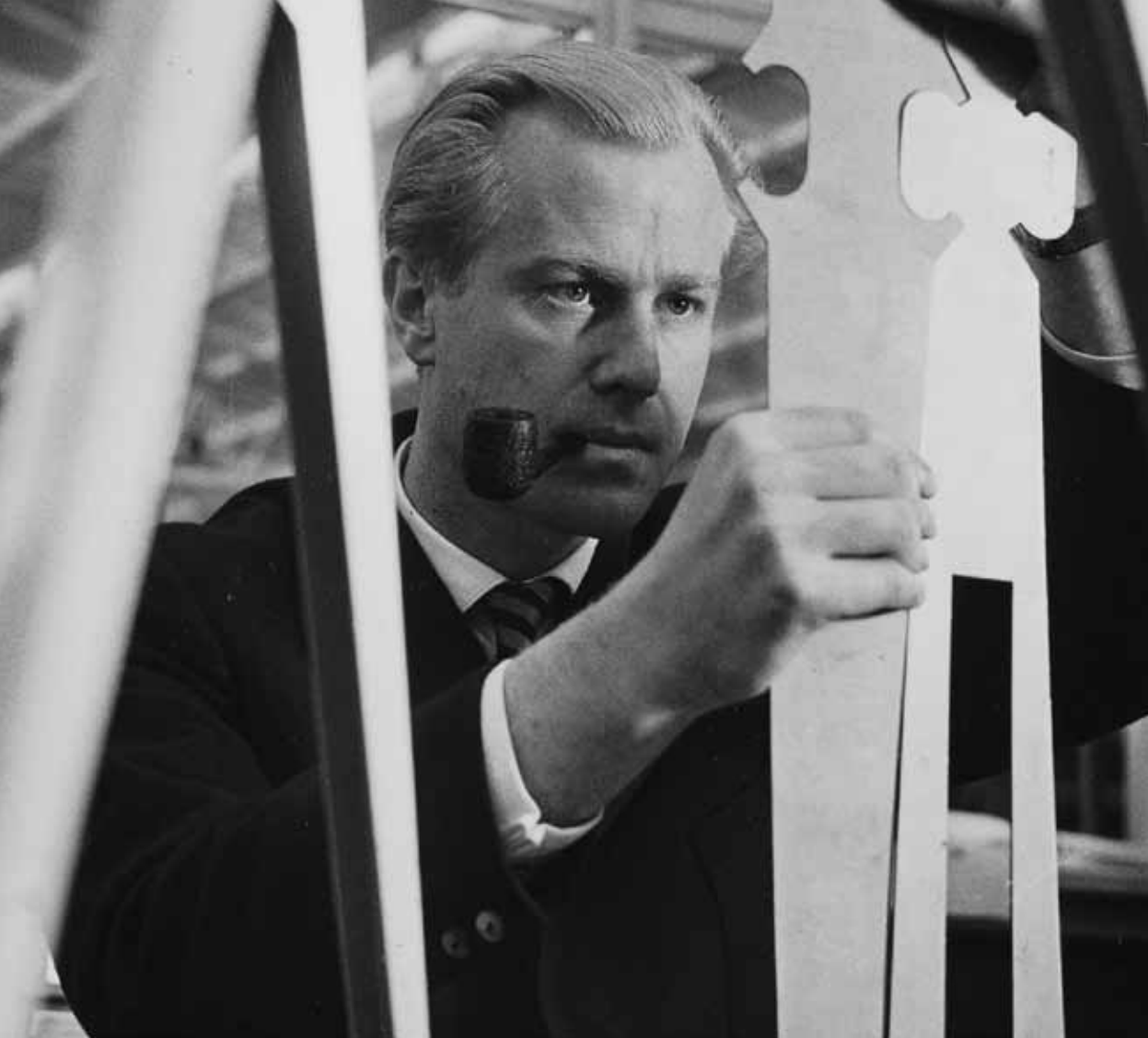
1956: Friso Kramer bekijkt gestanste blanks die worden gebruikt voor het onderstel van de Revoltstoel. Fotograaf Carel Blazer.
